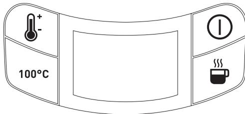
**I** Przycisk On/Off - wyświetla temperaturę wody w czajniku.
