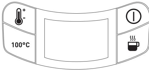
① Gumb za vklop/izklop – prikaz temperature vode v grelniku
