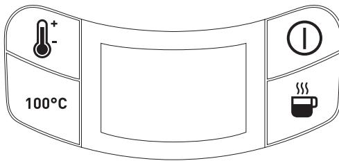
Dugme za uključivanje/isključivanje - prikaz temperature vode u kuhalu za vodu.
